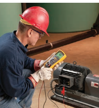
Проверка малых сопротивлений и целостности заземления соединений и обмоток электродвигателей
