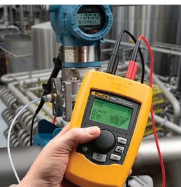
Калибраторы цепей Fluke надежны и точны. Модель 709Н позволяет базовый обмен информацией по HART (см. стр. 58).
