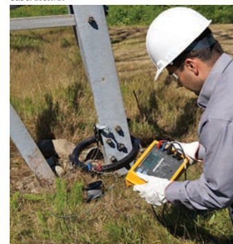
Трансформатор EI-162BN 320 мм (12,6 дюйма) с разъемным сердечником для использования с Fluke 1625-2
