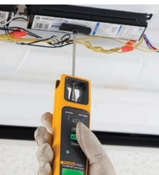
Простое определение работоспособности балластного сопротивления
