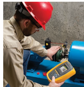
Получение моментальной проверки замеров при вращении вала
