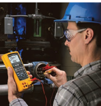
Простая калибровка измерительных преобразователей температуры с помощью калибраторов Fluke 725 и 726.
