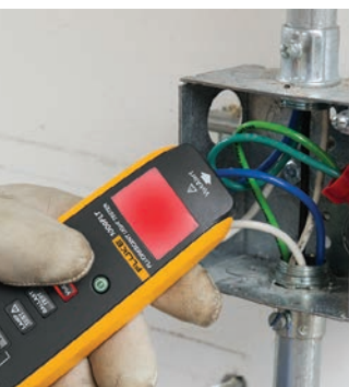
Быстрая проверка наличия напряжения без прикосновения к проводу под напряжением.
